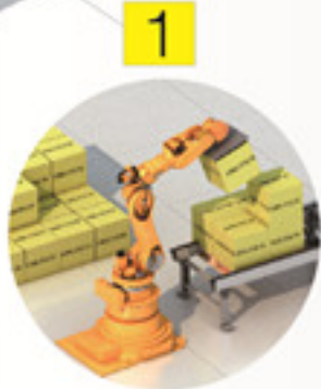
机械手码垛机 Stacker manipulator
